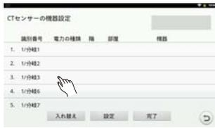
18. CT センサー対応表の「系統(電流)」の分岐番号をもとに機器を設定する分岐の行をタップする
