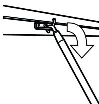
開：金具孔にフック棒を引っ掛けて手前に引き、ランマを回転させます。
