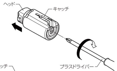
※ねじ1回転で約0.7mm上下します。キャッチ側面の目盛りを目安にして調整してください。
