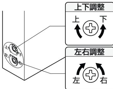
※左右調整する場合は、本体同士がぶつからないようにご注意ください。又、本体と中縦枠モヘアが接触しすぎて、開閉が重くならないよう調整してください。
