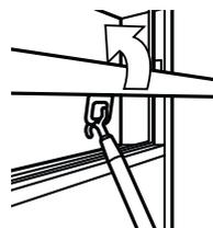
閉：金具のくぼみにフック棒をあて押し上げるようにしてランマを回転させます。
