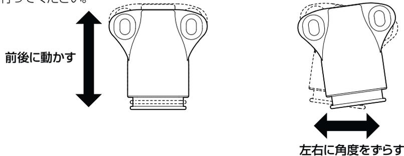
システム収納／タスボックス 引出し・引出し (ランドリー用)・スライド棚・スライドランドリーバーの取外し方法
