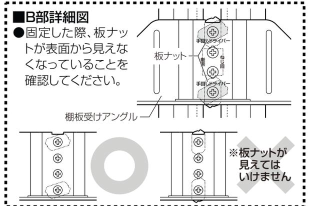
※ドライバーにて固定後、棚板受けアングルに下方向の荷重をかけ、しっかり固定されていることを確認してください。
