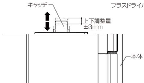
④キャッチを取付け穴に差込み、キャッチのヘッドを右に回してロックしてください。
