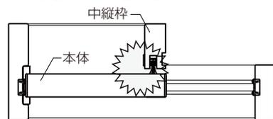
本体と中縦枠モヘアが接触しすぎると、開閉が重くなります。
