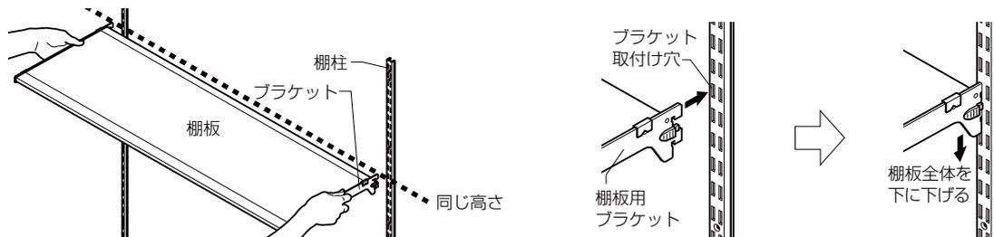
※必ず2本の棚板用ブラケットが同じ高さになるように設置してください。
