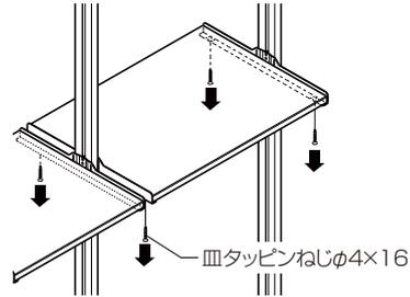
③棚受けアングルを固定しているねじをゆるめます。
