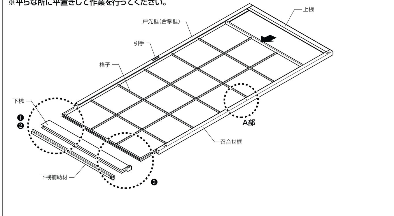
①下棧の底の調整ねじを左に回してゆるめ、下棧補助材キャップと下棧補助材を外します。
