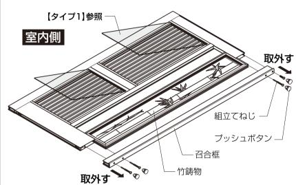
※取外したねじおよびプッシュボタンは、組立て時に再度 使用しますので、捨てないでください。 :※額縁はスライドして引抜いてください。
