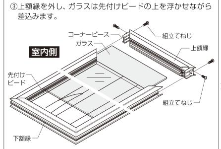
④先付けビードの位置がズレていないことを確認して、 外した額縁を取付け、後付けビードを回します。
