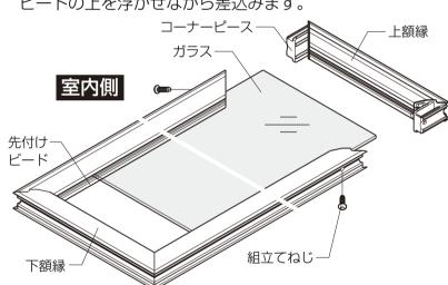
③先付けビードの位置がズレていないことを確認して、外し た額縁を取付け、後付けビードを回します。
