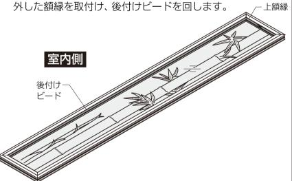
⑤ガラスを入れた額縁を障子へスライドさせて組込みます。 ⑥框上部キャップを取付けます。
