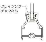
※ガラスを取付け、額縁組立て 後、形材端面を覆うように、 グレイジングチャンネルの 納まりに注意してください。
