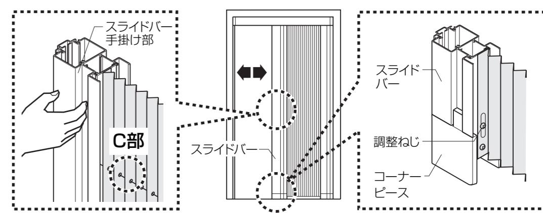
③ 下記「■ワイヤーの確認方法」を参照してワイヤーの張り具合を確認します。ワイヤーの張り具合が適切でない場合、調整ねじを上下方向に移動させてワイヤーの張り具合を調整します。
