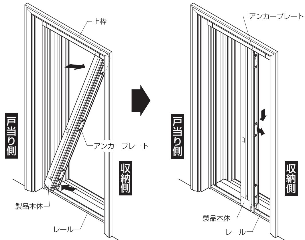
⑦製品本体の取付け時と同じ要領で製品が浮かないように収納枠
