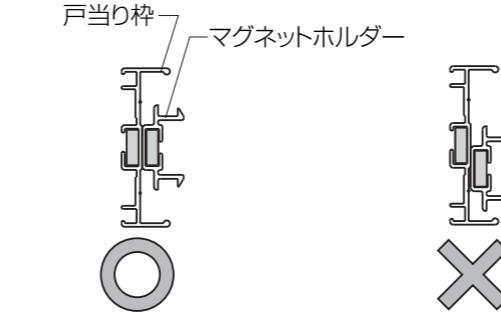
※ 上図のようにマグネットホルダーがずれて固定される場合は、マグネットの溝を図の通りにしてください。
