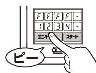
ONにしている間、コントローラーユニットから『ピッ』音が1秒間隔で鳴り続けます。▶ピッ▶ピッ▶ピッ▶ピッ▶ピッ
