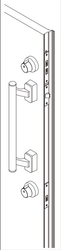
①-1 コネクターを引出してからシリンダーと金具を皿小ねじで固定します。
