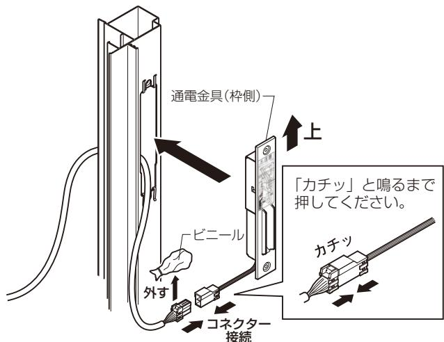
③通電金具（枠側）を枠に取付けてください。
