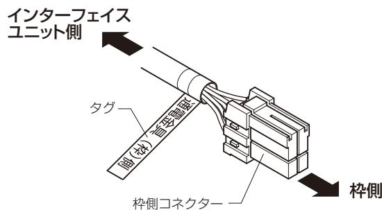
②軸体内配線コードの枠側コネクターは切欠き穴から確実に引き出してください。
