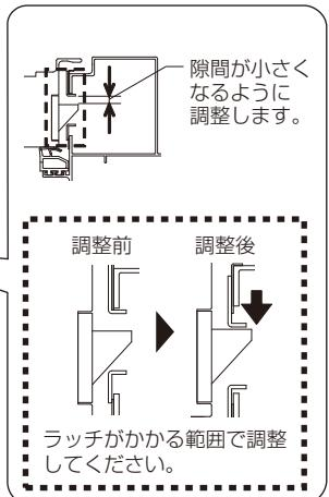
隙間が小さくなるように調整します。
