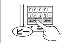
ON にしている間、コントローラーユニットから『ピッ』音が 1 秒間隔で鳴り続けます。▷ ピッ ▷ ピッ ▷ ピッ ▷ ピッ
