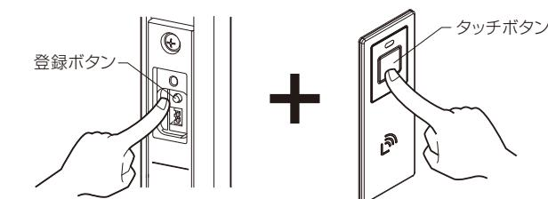
②「ピー」音が鳴り、LEDが橙色で5回点滅しますと全ての登録データが削除されます。
