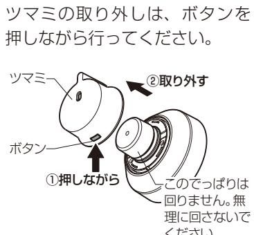
サムターンのツマミを取り外せますので、外出時に2個とも外しておけば、ガラス破りなどによる不正な操作を防げます。
