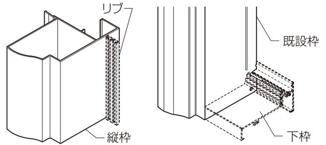
②かい物を三方に入れて、新しい枠の水平・垂直を正しく出します。
