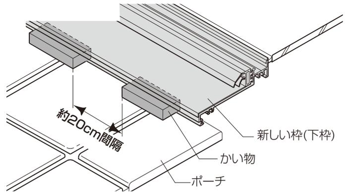
⑩躯体と新しい下枠の接合面(室内側)にシーリング材を充てんします。
