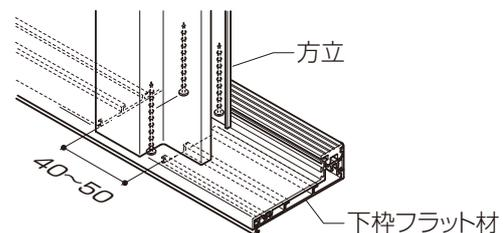
③下枠取付け穴から下枠フラット材を貫通させてドリルで $\phi 3.5$ の穴をあけ、③皿セルフタッピングアンカーねじ $\phi 4 \times 32$ で固定します。
