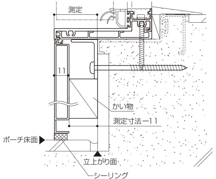
測定した寸法-11mmにした厚みのかい物を、巾木と同じ全長寸法で準備してください。
