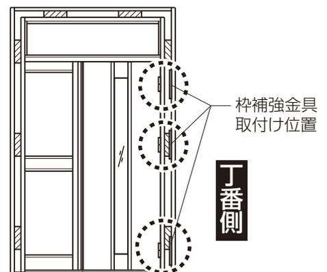
⑤縦枠の室外側の固定穴から、枠補強金具を㊸なベタッピンねじφ4×30(1種)で固定します。
