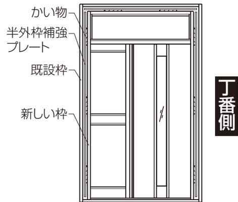
④新しい枠を①なべドリルねじ(粗目)φ4×40で取付けます。(同梱品のねじは使用しません。)
