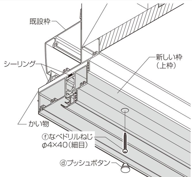
⑥本体・子扉部分の下枠ゴムカバーを取外し、下枠の取付け穴から既設下枠に $\phi 3.5$ の下穴をあけて、皿ドリルねじ $\phi 4 \times 40$ で既設枠に固定します。
