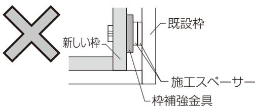
④縦枠の室外側の固定穴から、枠補強金具を②なベタツピンねじφ4×30(1種)で固定します。
