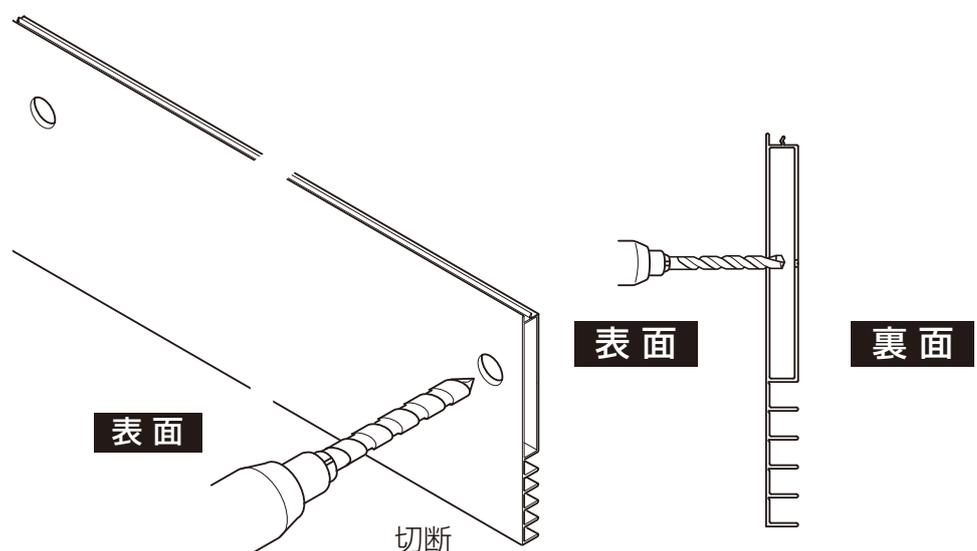
④ポーチ床面と、下枠との段差に合わせて、シーリング代を確保し巾木を溝にそって切断します。
