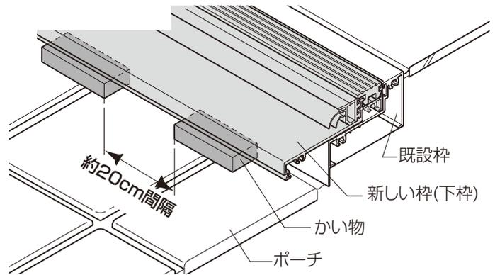
⑨既設枠と新しい下枠の接合面(室内側)にシーリング材を充てんします。
