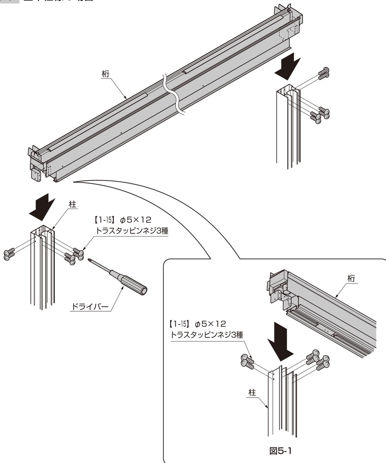
①桁を柱に【1-15】で取付けてください。
