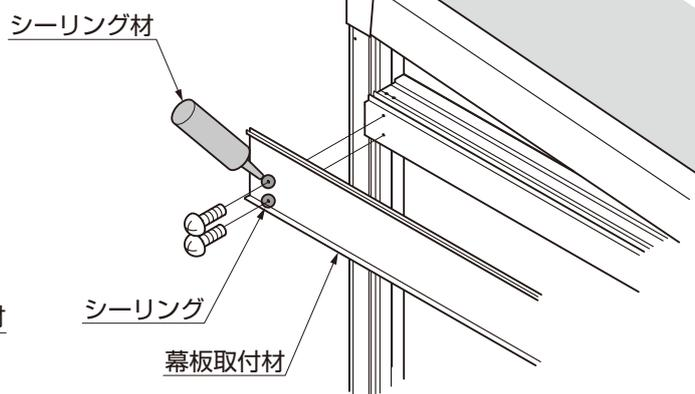
図1-18 幕板取付材ネジ打込み部
