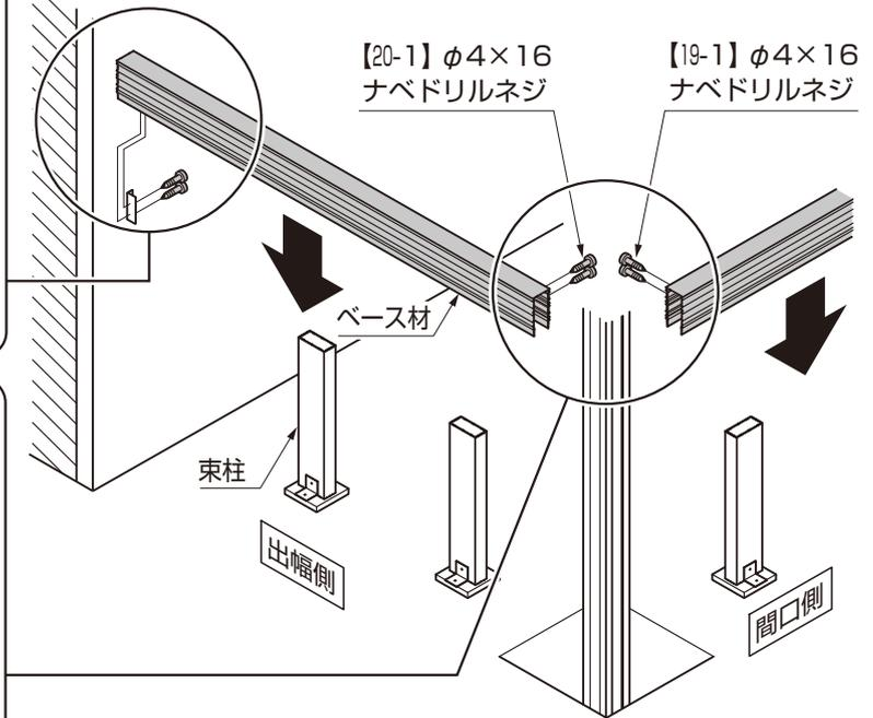
①ベース材を束柱の上に置き、ベース材取付部品に【19-1】、【20-1】で取付けてください。
