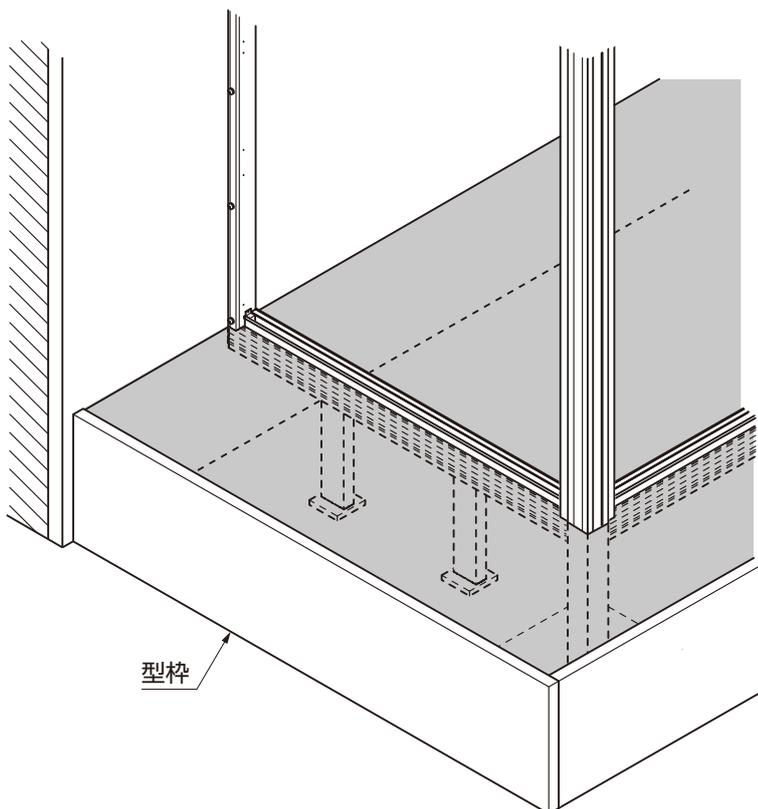
①基礎穴のコンクリートが養生できたのを確認し、型枠を固定しF.L.までコンクリートを打設してください。
