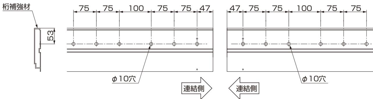
① 桁補強材にφ10の穴をあけてください。
