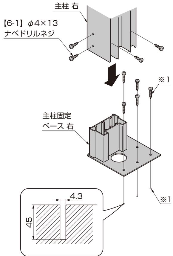
図3-12 主柱(右用)の固定
