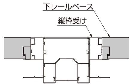
図 1-9 中間柱、連棟柱の場合
