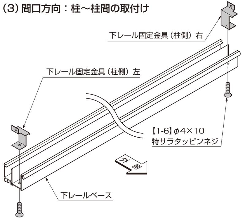
①下レール固定金具 (柱側) を下レールベースに【1-6】で取付けてください。
