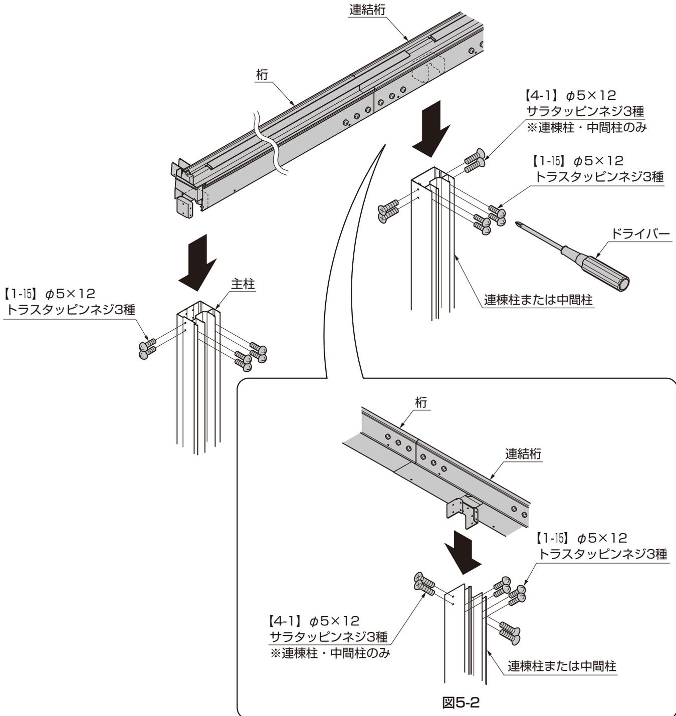
① 桁を柱、連棟柱または、中間柱に【4-1】、【1-15】で取付けてください。
