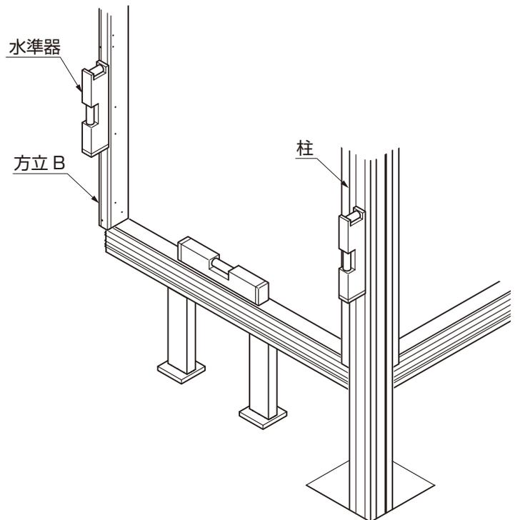
①下レールベースをベース材に固定する前に水準器などで方立 B、柱、ベース材の水平・垂直を確認してください。
