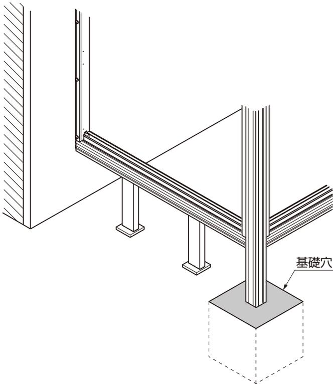
①基礎穴にコンクリートを打設し、養生してください。
