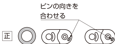
図3-6 網戸上部のキャタピラの向き
