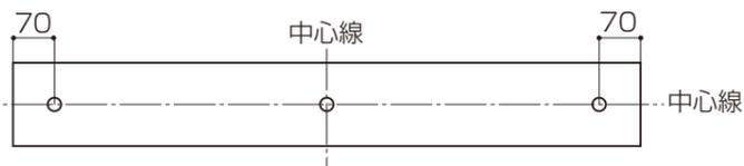
②下地材を指定の取付け位置に、同梱の仮固定ねじ(DNねじφ3.8×65)で水平に取付けてください。
