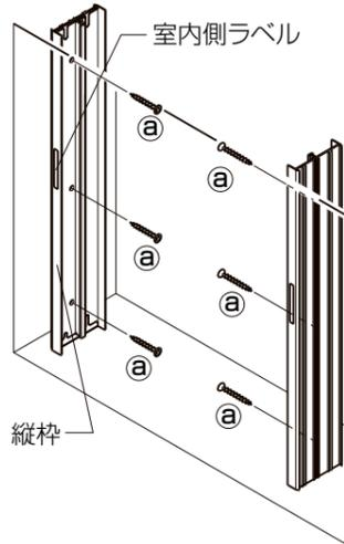
※縦枠の向きは縦枠に張ってあるラベルを参照してください。
