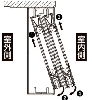
**5 化粧カバーの取付け** (インプラス for Renovationの場合のみ)
