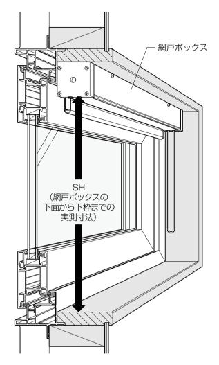
※ガイドレールは、レールキャップがついていな い側(上側)を切断し、インナーレールは切断後、 溝端部にV加工がされている側を上になる様に セットしてください。
