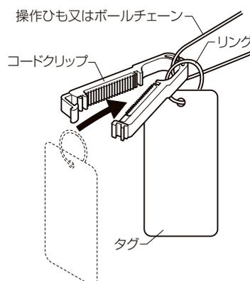
②コードクリップへ操作ひもやボールチェーンを通したら、コードクリップ先端を閉じ、ロックをかけてください。
