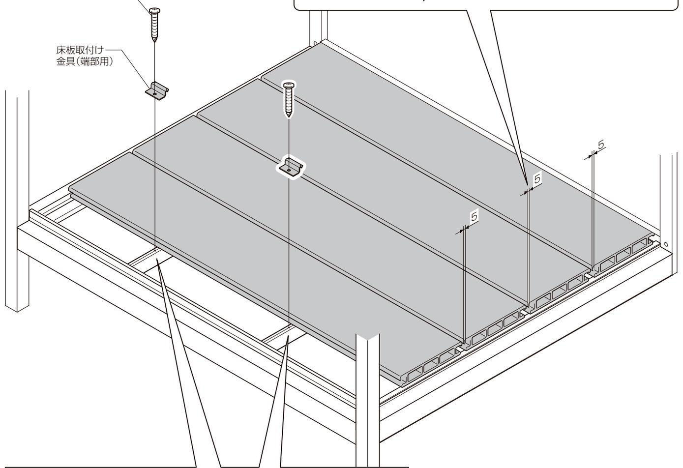
●最後に床板取付け金具(端部用)を取付けてください。
