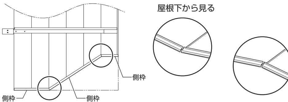
※異形対応の場合、側枠の継ぎ目部分より排出されます。
