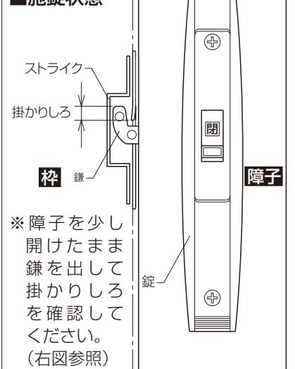
※障子を少し開けたまま鎌を出して、鎌の先端がストライクの2本線内にあることを確認してください。(右図参照)
