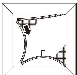
③さらに縦のアタッチメントをゆっくりと下に引っ張り、上のアタッチメントを外してください。端が外れたら、残りの部分は手で引っ張って外してください。
