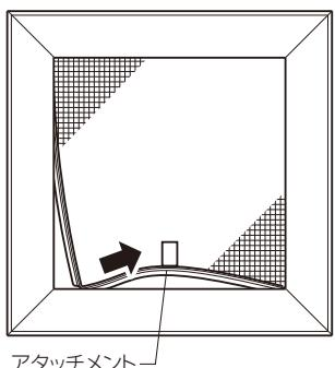
①網戸取外しタグを持ち、上に引っ張り、下のアタッチメントを外してください。
