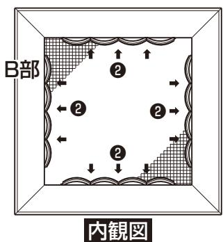
※はめ込む前に網戸コーナー部のアタッチメントにすき間がある場合は、①長い方のアタッチメントを先に金具の根元まで押し込み、続いて②短い方のアタッチメントを金具に押し込んでから網戸を取り付けてください。
