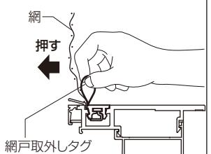
②次に下のアタッチメントを横方向へゆっくりと引っ張り、縦のアタッチメントを外してください。端が外れたら、残りの部分は手で引っ張って外してください。
