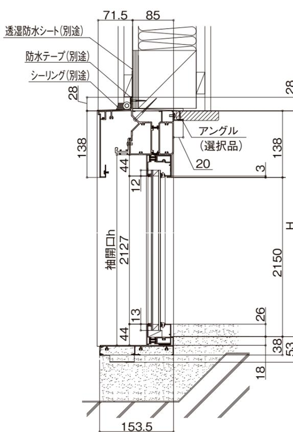
●縦断面図〔片袖枠 リニアスライド時開口部上部〕
