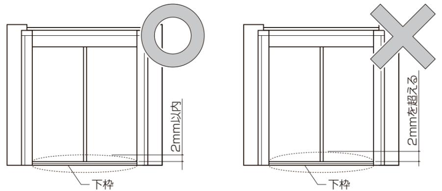
②下げ振り・水準器で枠のねじれ・倒れ・ゆがみを直した後、本固定します。
