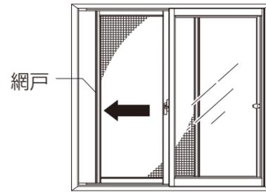
③網戸の縦框のリブにストッパーの溝を挿入します。
