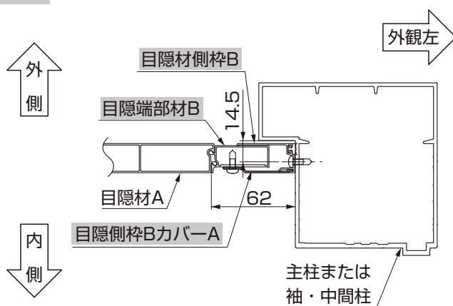
図2-6 部材断面図
