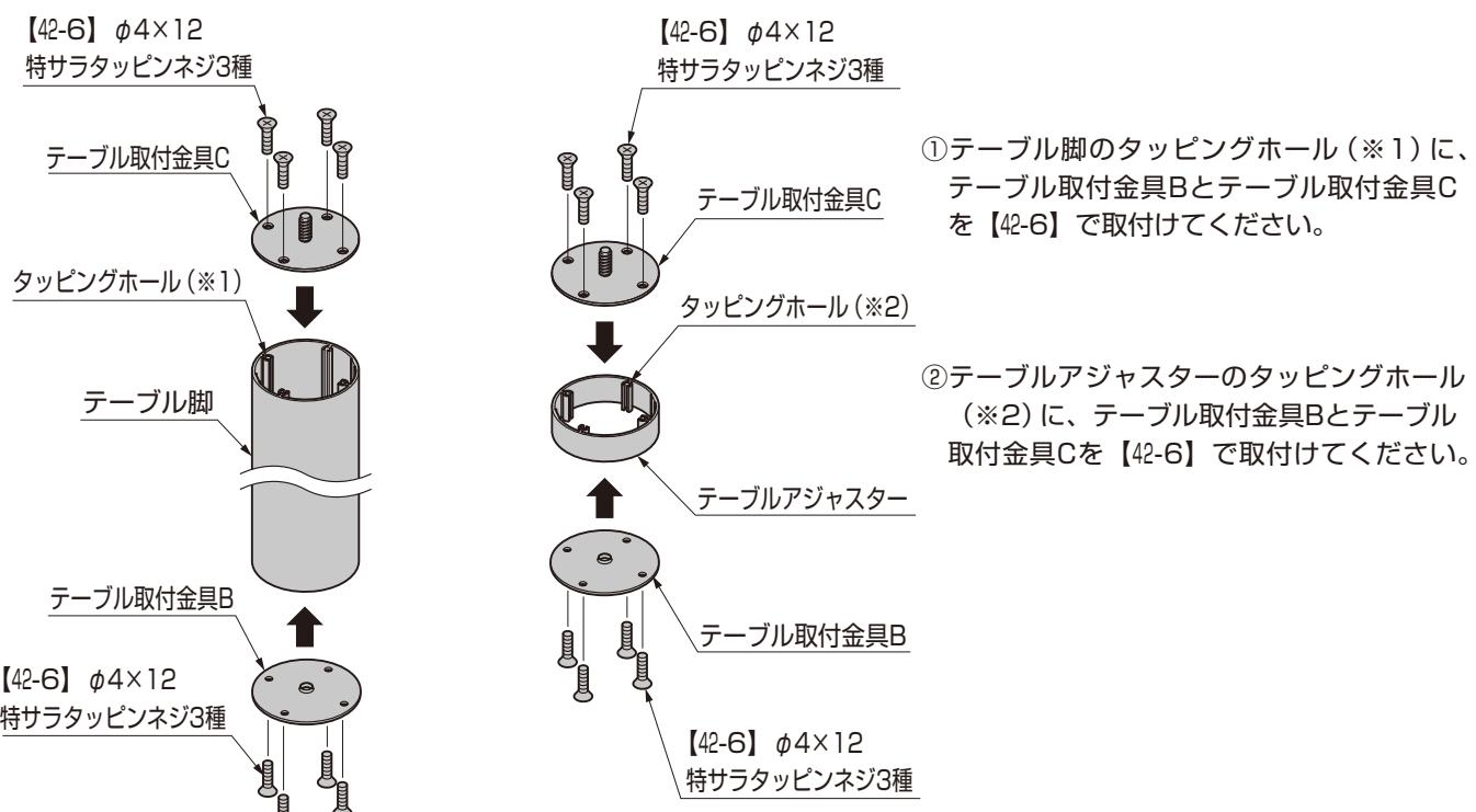
図5-1 テーブル脚の組立て　　図5-2 テーブルアジャスターの組立て
