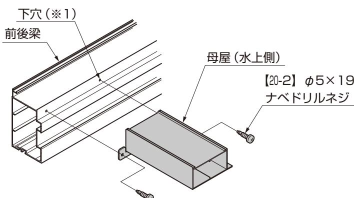
図13-3 母屋の取付け（水上側）
