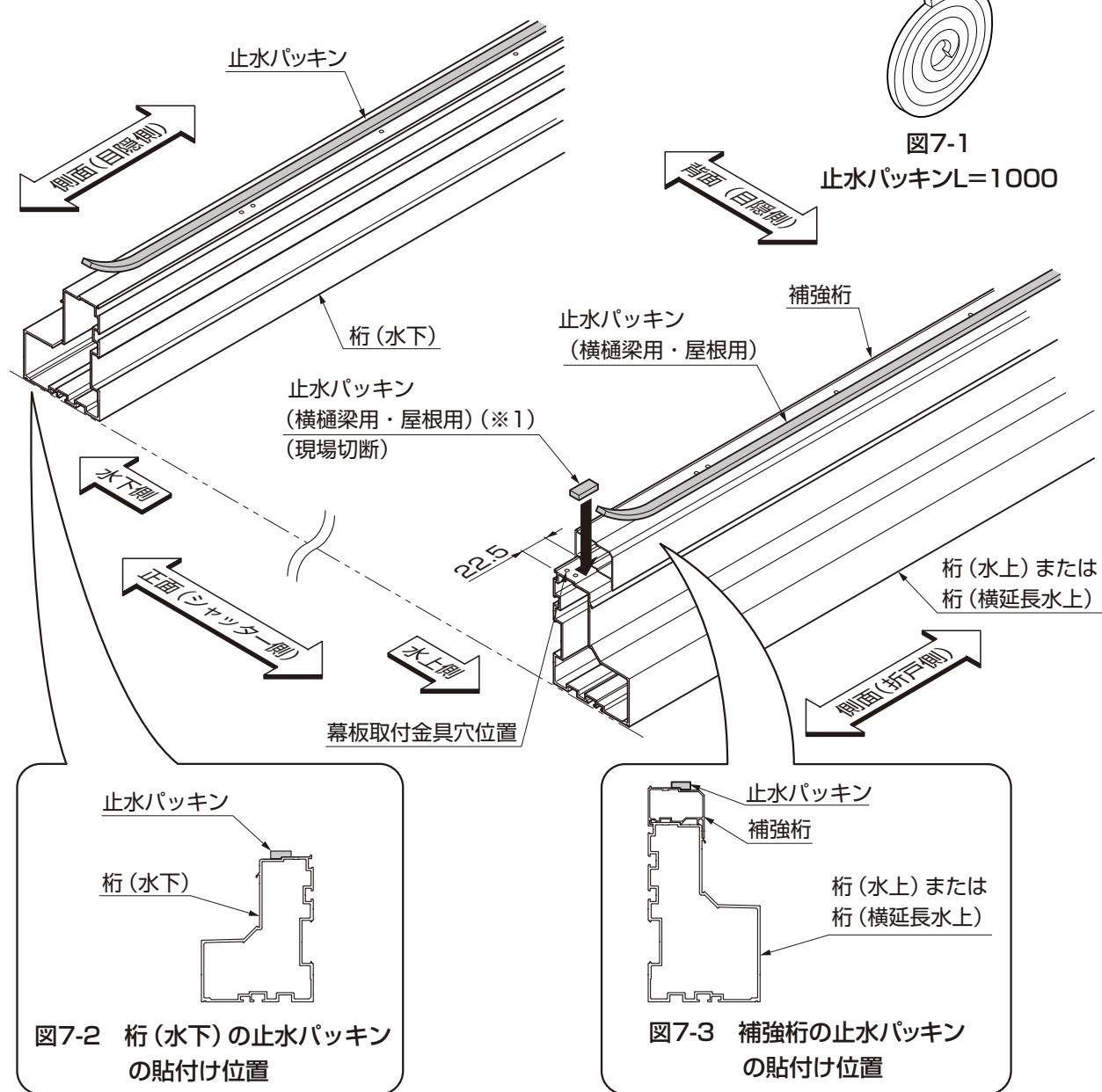
①水上側の補強筋に、止水パッキン(横樋梁用・屋根用)の裏面のシールをはがして貼付けてください。
