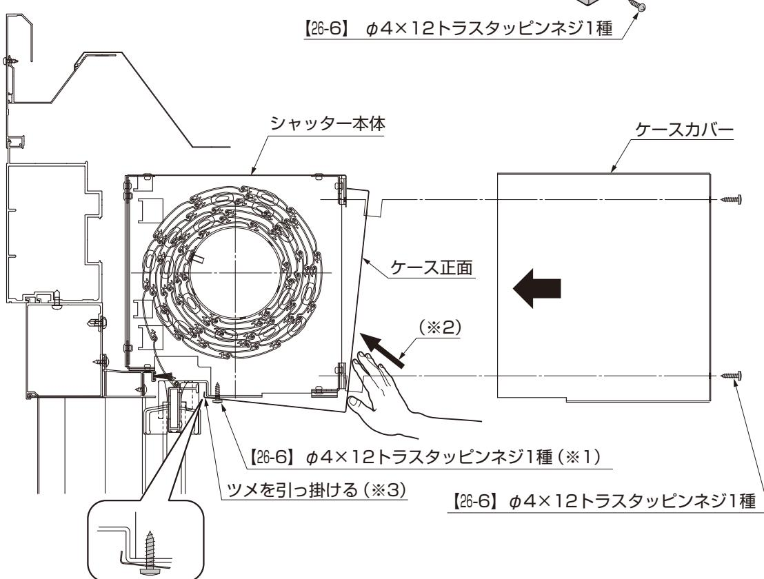
①ケース正面のツメを、シャッター本体の下面に引っ掛けて（※3）、【26-6】（※1）で固定してください。
