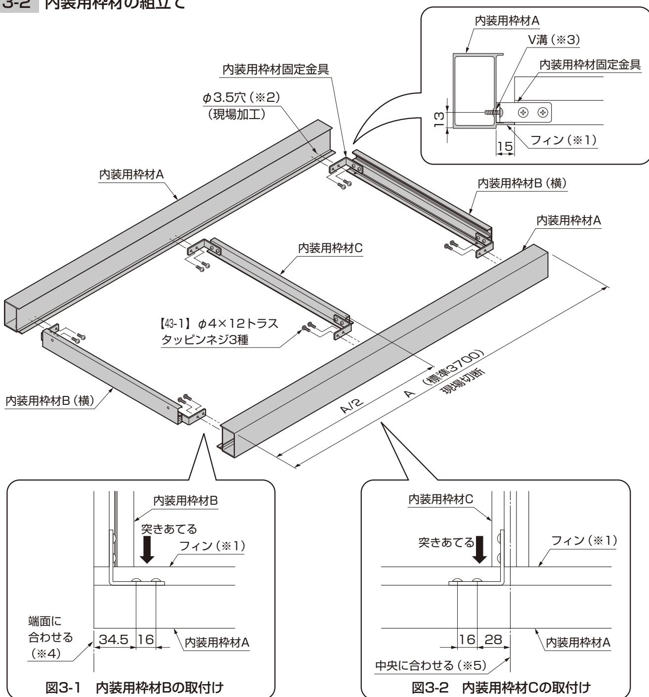
①内装用枠材Aに、内装用枠材Bまたは内装用枠材Cを突き当てる、内装用枠材固定金具を当てて、 $\phi 3.5$ の下穴（現場加工）（※2）をあけてください。（図3-1、図3-2参照）
