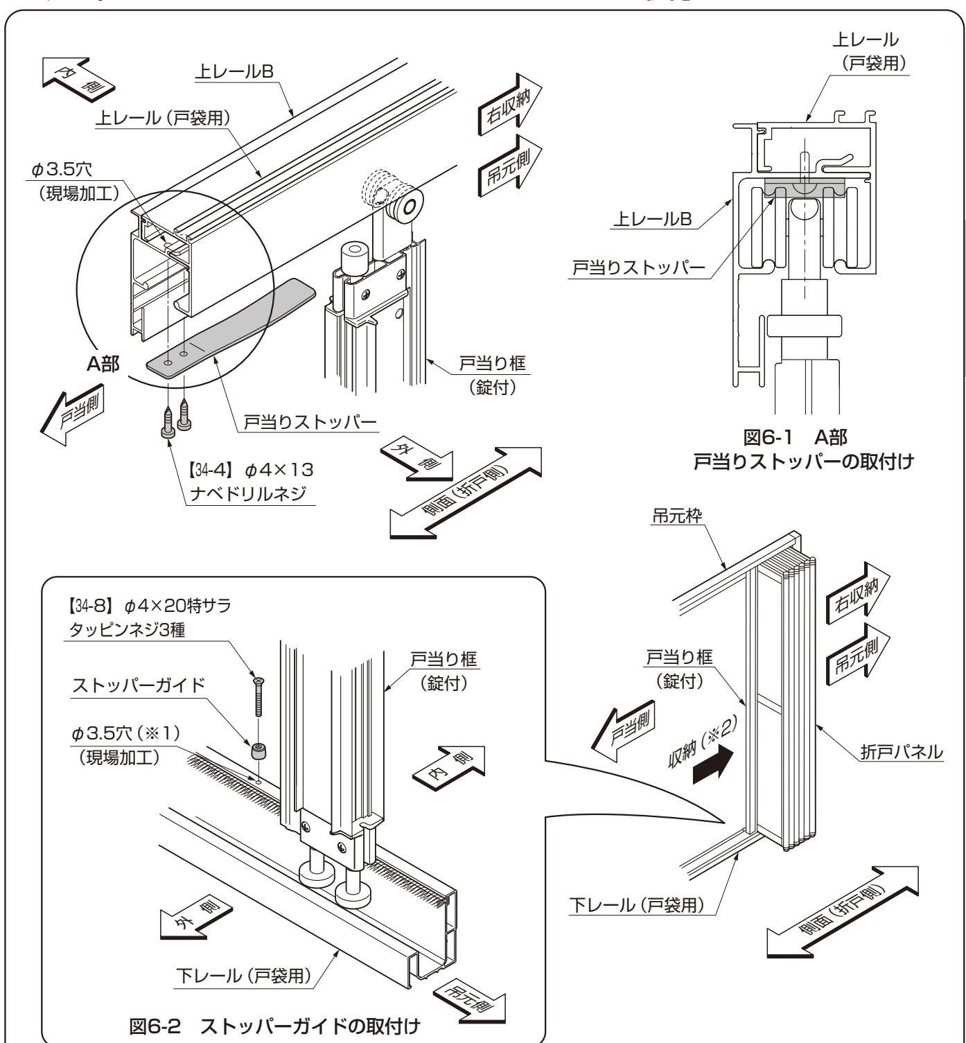
①「8 折戸レールの取付け 4.上レールA・上レール戸袋用の取付け 4-1 上レールBの加工」で加工したφ3.5穴 (現場加工)に【34-4】で戸当りストッパーを取付けてください。
