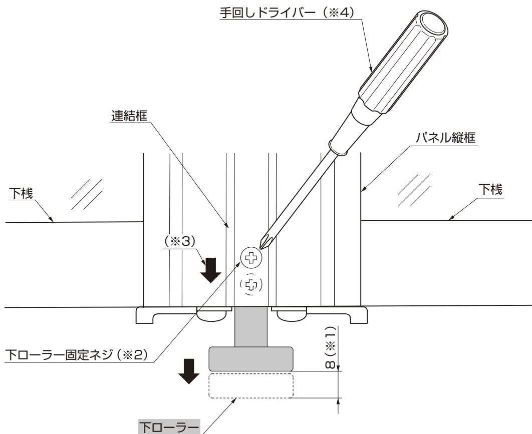
① 下ローラーを移動して、折戸パネルの調整をしてください。
