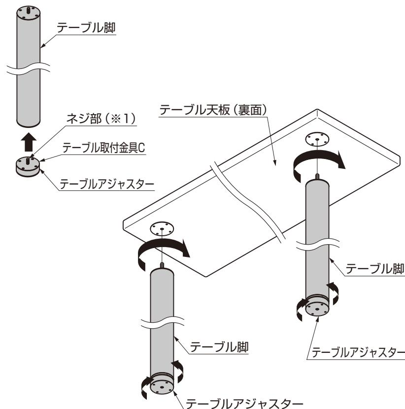
① テーブルアジャスターのテーブル取付金具Cのネジ部(※1)を、テーブル脚のテーブル取付金具Bに差し込んで、回転して取付けてください。
