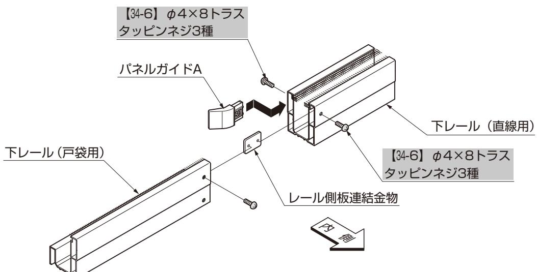
図1-14 下レール(戸袋用)と下レール(直線用)の取付け
