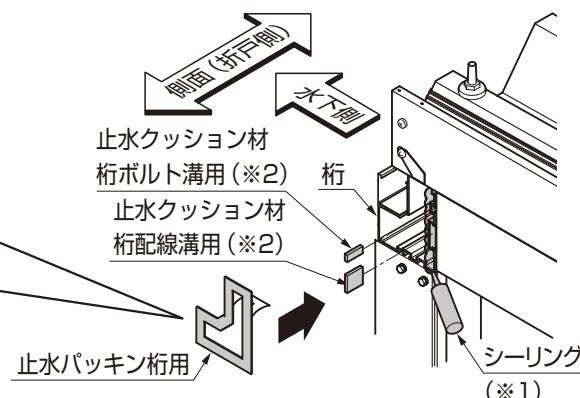
図18-11 水下側止水パッキンの貼付け
