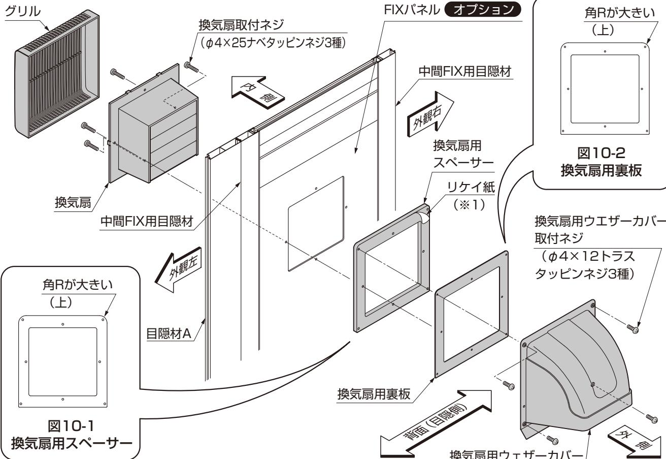
①換気扇用スペーサーのリケイ紙をはがして(※1)換気扇用FIXパネルのネジ穴に合わせて、貼付けてください。
