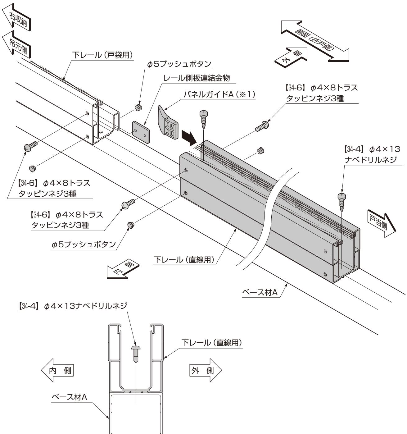
図8-1 下レール(直線用)の取付け
