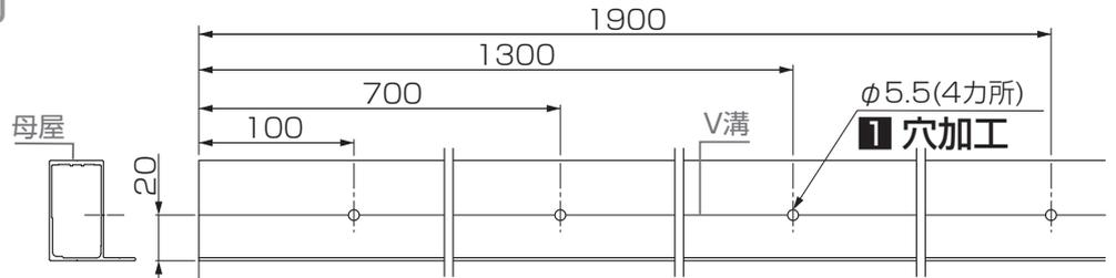
2: 母屋補強材の側面にφ4.5の穴加工
