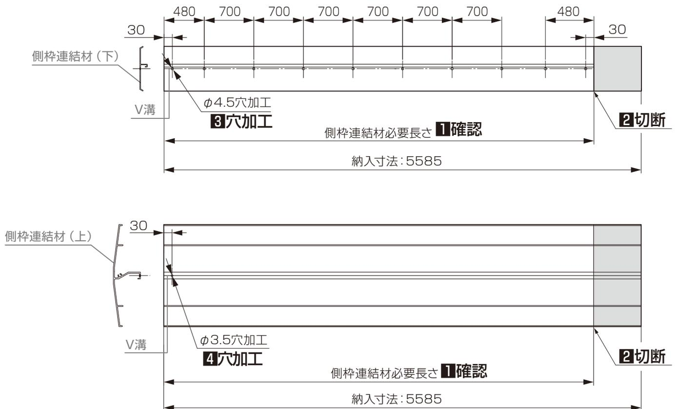
※本図はノーマル枠を示す。プラス枠用も同様の加工
