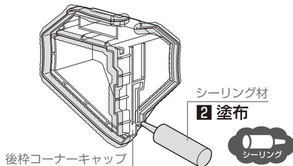
3: 後枠コーナーキャップを後枠にはめ込む
