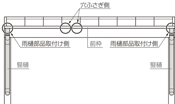
1: 雨樋パッキンと雨樋アタッチメントを前枠の水抜き穴に【18-3】で取付け
