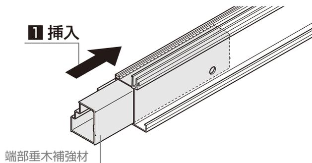
2: 端部垂木補強材を端部垂木に【18-3】で取付け
