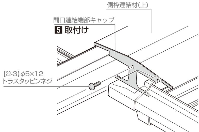
6: 側粋連結材(上)と間口連結端部キャップの接合部にシーリングを塗布
