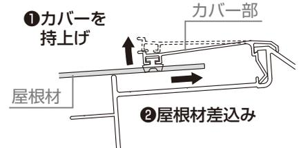
3: 屋根材を前枠の屋根材受けに突き当て
