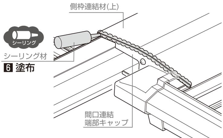
7: 間口連結端部キャップと屋根面、側粋接合部にシーリングを塗布
