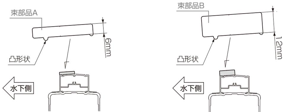
1: 梁に取付けた梁スペーサーと端部垂木・中間垂木を取付けるネジ・束部品の位置と組合せの確認
