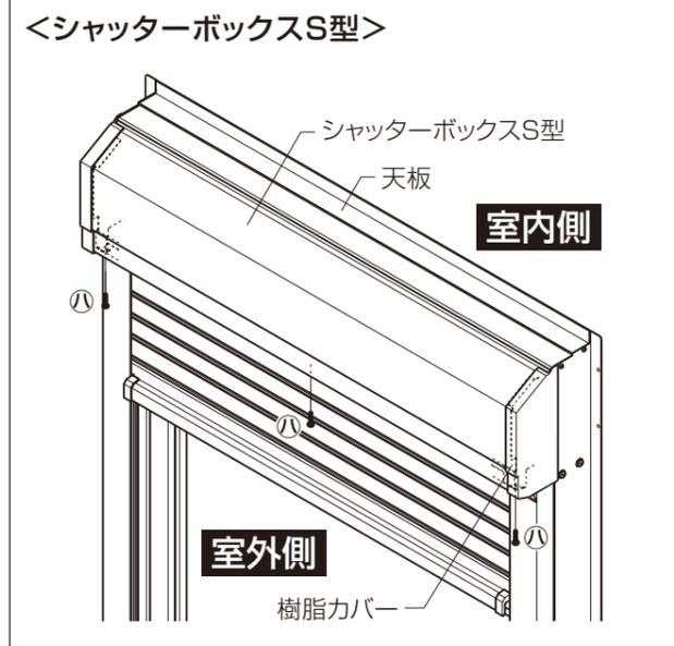
①シャッターボックス引っ掛け部を天板の溝にもぐりこませ、回転させるように取付けます。
