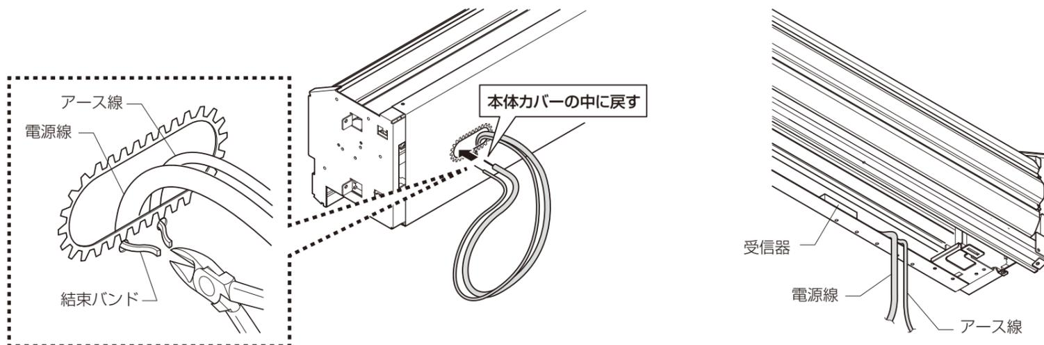
③電源線とアース線はスラットと干渉しないよう本体カバーの下部(A部)を這わせて、下図のA～Cのいずれかの位置に固定しておきます。このとき配線の高さが受信器の高さ(25mm)を超えないよう、結束バンドやコードクランプ(別途手配品)を使用して配線の浮きを防止してください。
