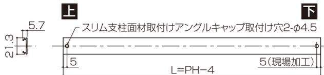
●面材取付けアングルアタッチ スリム支柱用(YGA□742)
