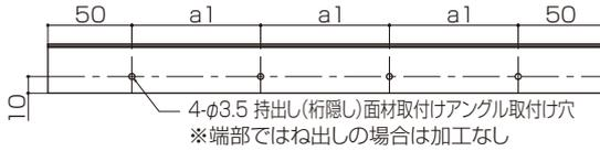
●持出し(桁隠し)四方枠用上下枠(YGA□642)
