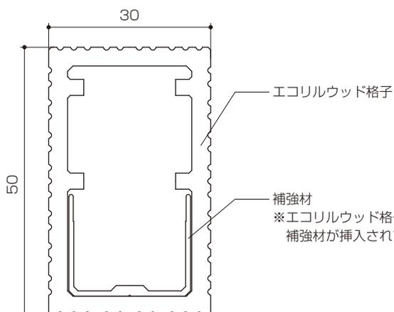
※エコリルウッド格子は、補強材が挿入されています。
