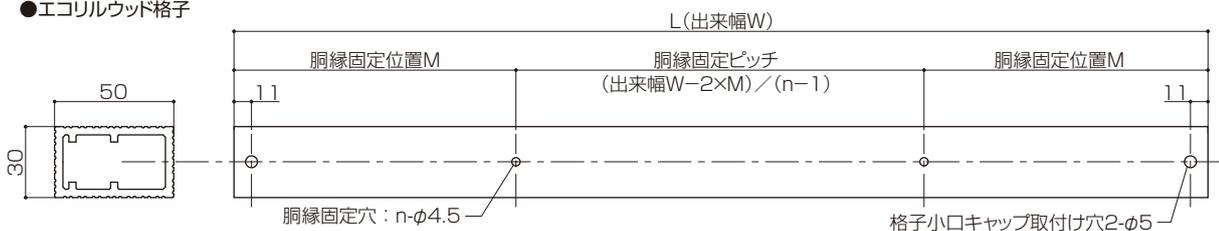
※胴縁固定穴は、エコリルウッド格子と補強材を挿入したまま同時にφ3.5穴を加工すると効率よくできます。
