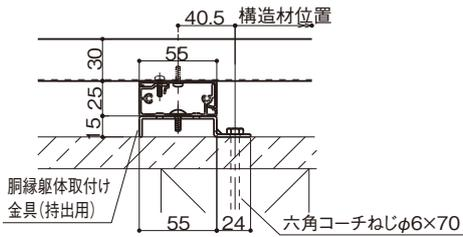
●コーピング下 躯体納まり (胴縁取付け材直固定の場合)
