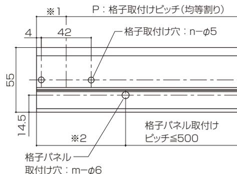
● 格子取付け穴・格子パネル取付け穴寸法表(mm)
