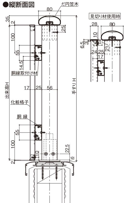
■構造組立て説明図(バルコニー直付け納まり)
