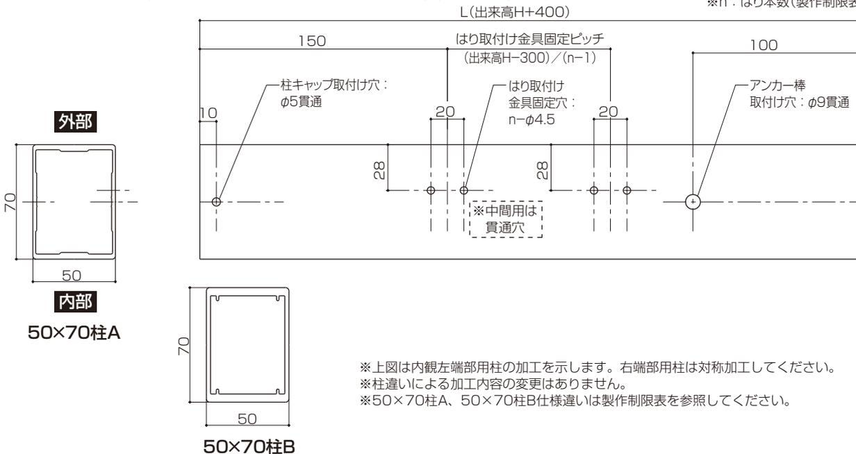
※上図は内観左端部用柱の加工を示します。右端部用柱は対称加工してください。
