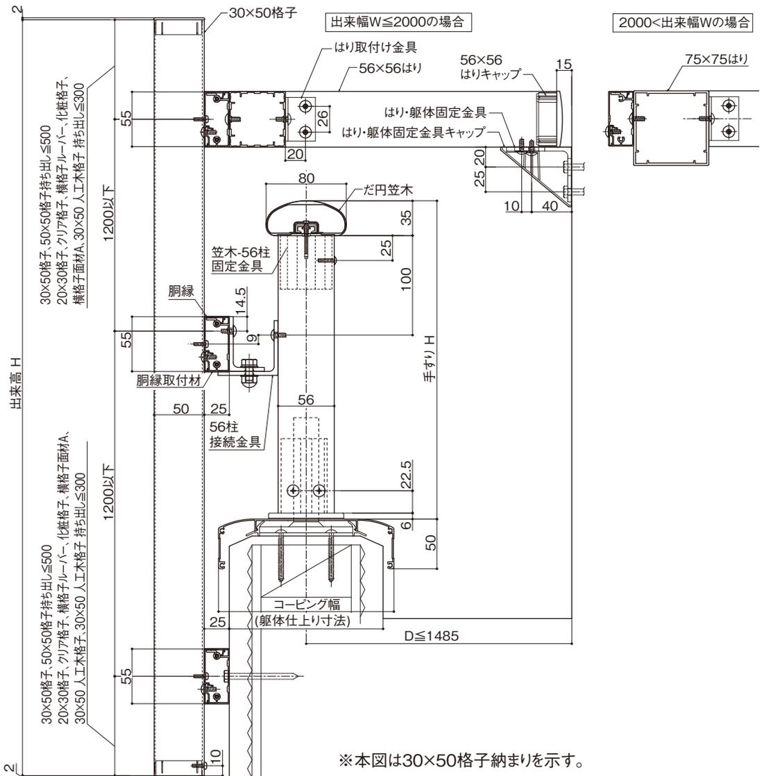
■構造組立て説明図(バルコニー持出し納まり(ハイスクリーン))横格子
