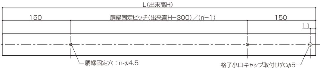
※胴縁固定穴は、エコリルウッド格子と補強材を挿入したまま同時に  $\phi 3.5$  穴を加工すると効率よくできます。
