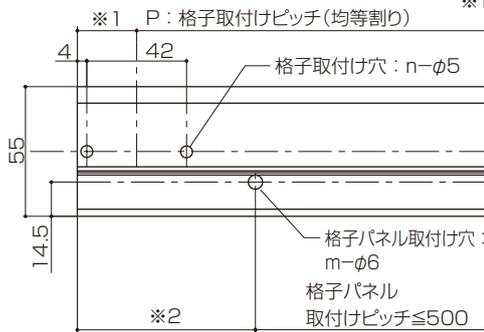
● 格子取付け穴・格子パネル取付け穴寸法表(mm)
