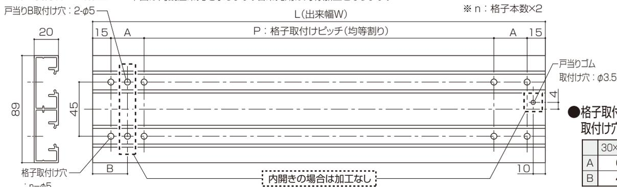
●**格子取付けピッチ・戸当りB取付け穴寸法表(mm)**
