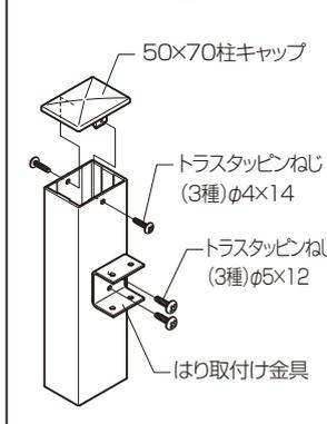
●70×70コーナー柱・はり取付け金具の取付け
