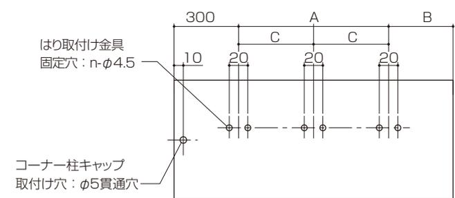
●50×70柱キャップ・はり取付け金具の取付け
