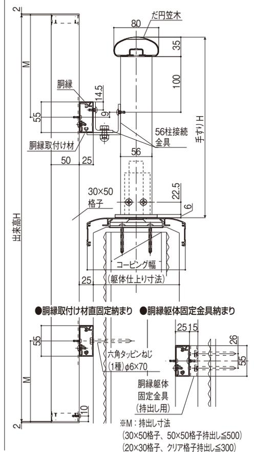
●胴縁取付け材直固定納まり ●胴縁躯体固定金具納まり
