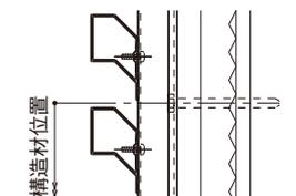
■構造組立て説明図(バルコニー直付け納まり)
