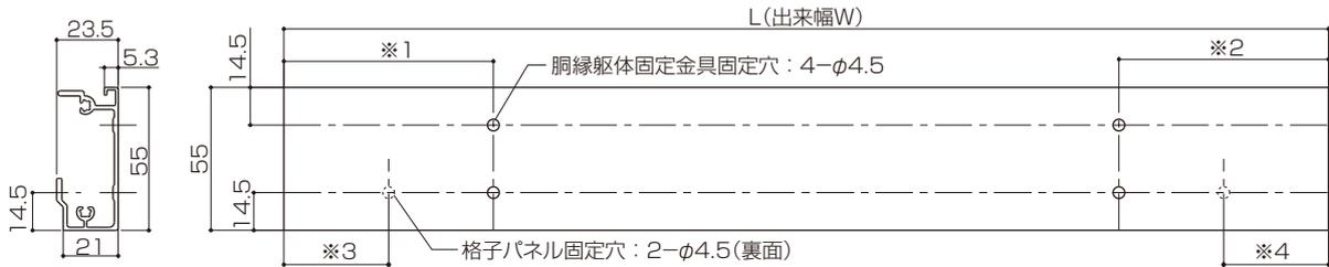
●格子固定穴・格子パネル取付け穴寸法表(mm)
