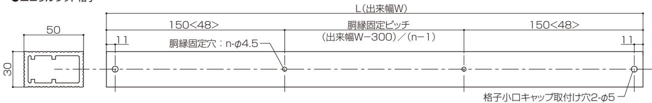
※胴縁固定穴は、エコリルウッド格子と補強材を挿入したまま同時にφ3.5穴を加工すると効率よくできます。
