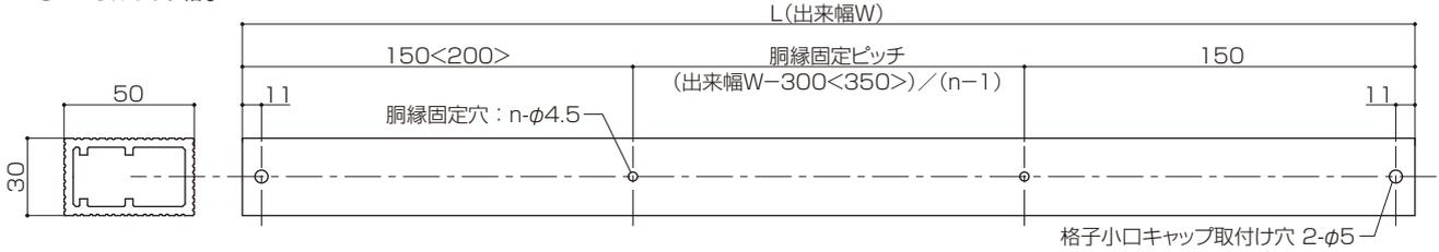
※ 胴縁固定穴は、エコリルウッド格子と補強材を挿入したまま同時にφ3.5穴を加工すると効率よくできます。
