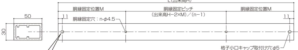
※胴縁固定穴は、エコリルウッド格子と補強材を挿入したまま同時にφ3.5穴を加工すると効率よくできます。
