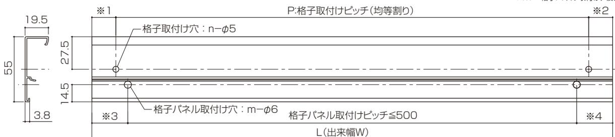
●**格子取付け穴・格子パネル取付け穴寸法表(mm)**
