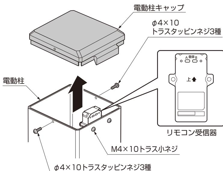
①電動柱キャップを電動柱から外してください
