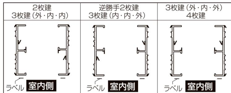
※縦枠の位置出しは下図のように外窓室内側から一定にしてください。
