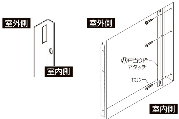
※浴室などの水のかかる場所でご使用の場合は、取付けねじ頭周辺と長穴に、必ずシーリング処理をしてください。
