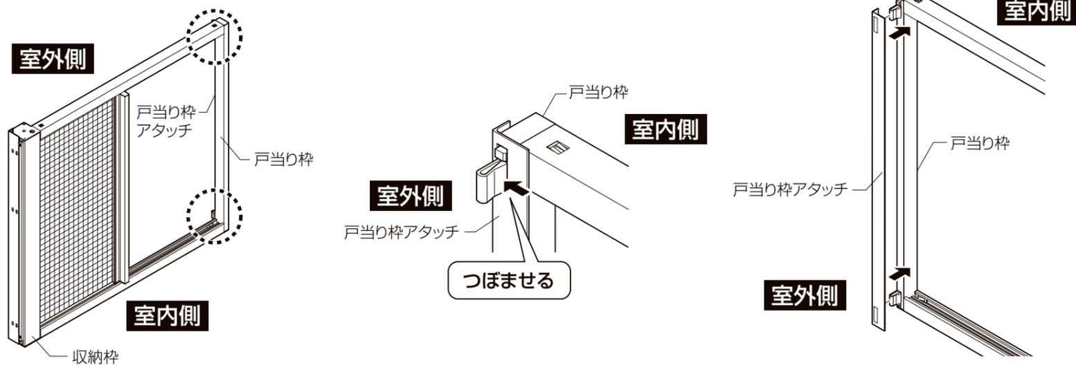
②①戸当り枠を外してから、②収納枠を収納枠アタッチから外します。
