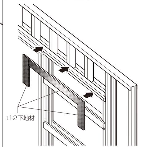
②点検口開口部に合わせて、点検口を下地材にねじで（現場手配）固定します。
