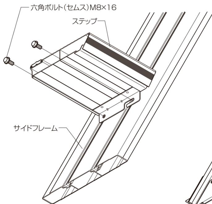
②ステップを回転させて、水平を確認してステップとサイドフレームを本締めした後、アタッチメントとサイドフレームをねじ止めて固定してください。
