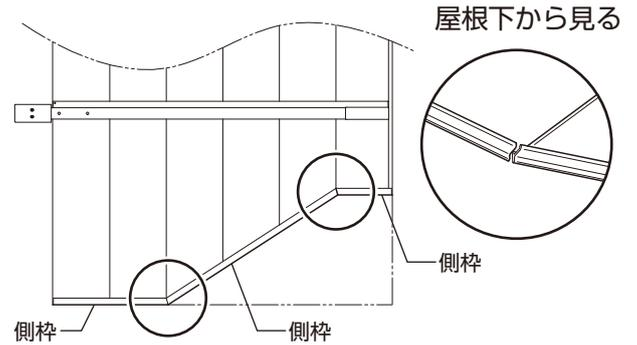
※異形対応の場合、側枠の継ぎ目部分より排出されます。
