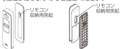
上側にずらしてリモコン裏側の溝にホルダの突起を入れます。その後、下側にずらすとホルダの突起が溝に収まります。取る時は、上にずらしてから取出します。
