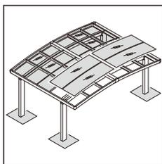
①屋根材を2台用棟木のカバー部に差し込み、後枠の屋根材受けに差込んでください。
