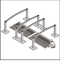
①2台用棟木・母屋・後枠・母屋スリーブを穴加工してください。
