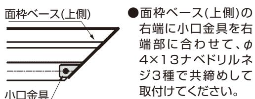
②面枠ベース(上側)を墨に合わせて【20-1】 $\phi 4 \times 16$  ナベドリルネジ3種で取付けます。
