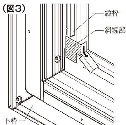
④(図4)の斜線部を折曲げ、下枠に張付けてください。
