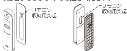
上側にずらしてリモコン裏側の溝にホルダの突起を入れます。その後、下側にずらすとホルダの突起が溝に収まります。取る時は、上にずらしてから取ります。
