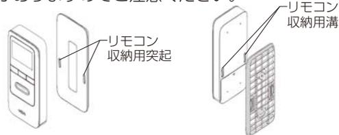
リモコン裏側の溝にホルダの突起を入れます。磁石で取付けます。
