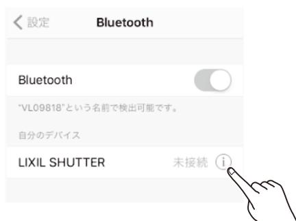
シャッターまたは電動ユニットの接続情報が残っていると「LIXIL SHUTTER」と表示されます。情報を消したいシャッターまたは電動ユニットのinfoボタン「①」をタップしてください。
