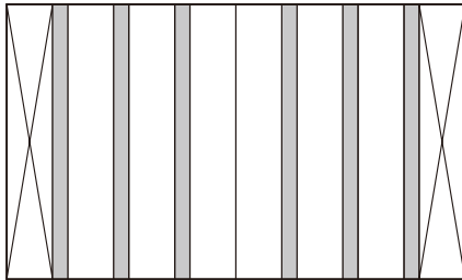
幅60サイズ スチール折板 8枚 1山ポリカ折板 6枚
