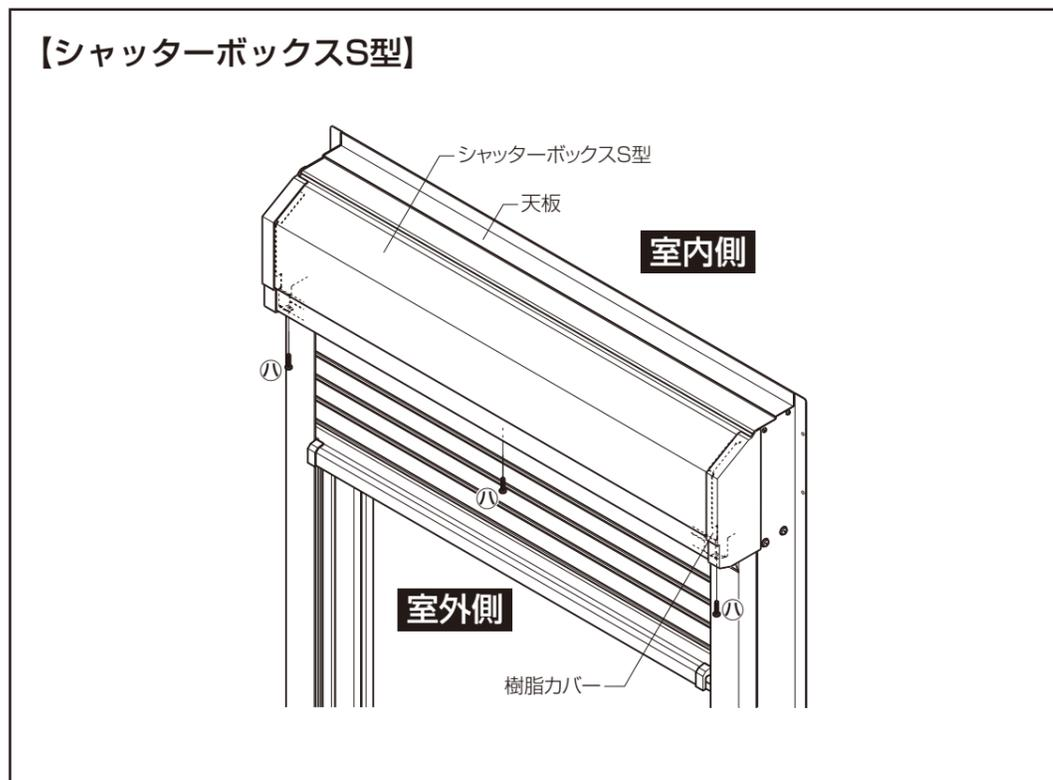
① シャッターボックス引っ掛け部を天板の溝にもぐりこませ、回転させるように取付けます。
