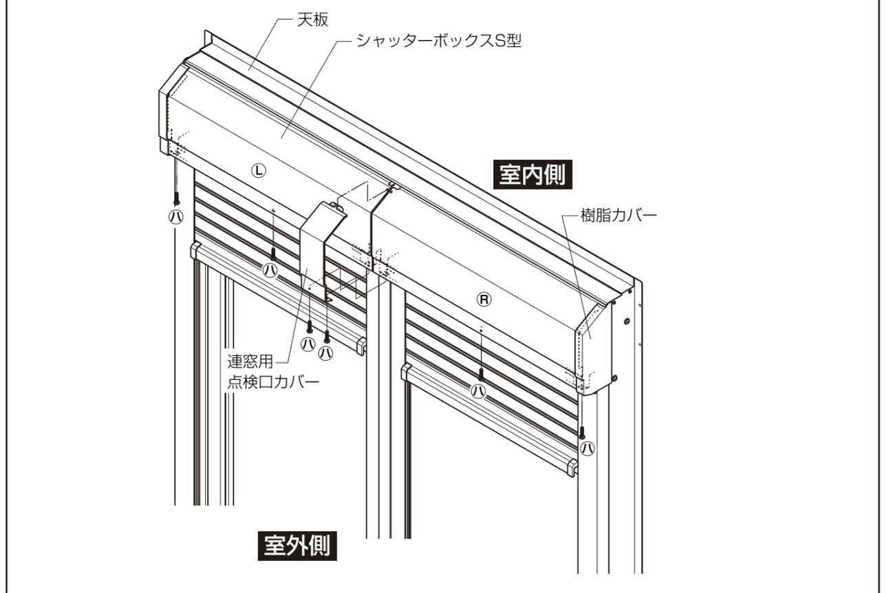
① シャッターボックス引っ掛け部を天板の溝にもぐりこませ、回転させるように取付けます。
