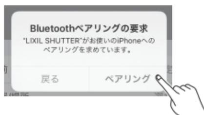
登録確認画面が出ますので「ペアリング」をタップします。Android端末の場合「ペアリングの要求」画面が表示されません。画面右上の「保存」をタップしてください。タップしてペアリングが完了するとシャッターが小さく上下に動きます。
