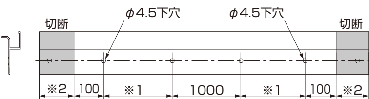
図6-25 天井端部枠の加工
