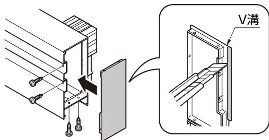
①前後フレーム端部キャップを切断して前後フレームに【9-1】で取付けてください。
