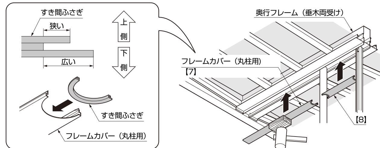
図12-2 フレームカバー（丸柱用）の取付け
