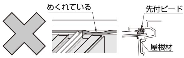
●屋根材挿入後、先付けビードがめくれていないことを確認してください。先付けビートがめくれていると、雨漏れの原因となります。
