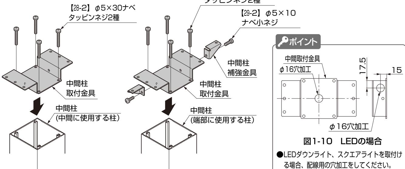
①中間柱取付金具を中間柱に【28-2】で取付けてください。
