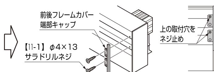
②前後フレームカバー端部キャップを前後フレームに【11-1】で取付けてください。
