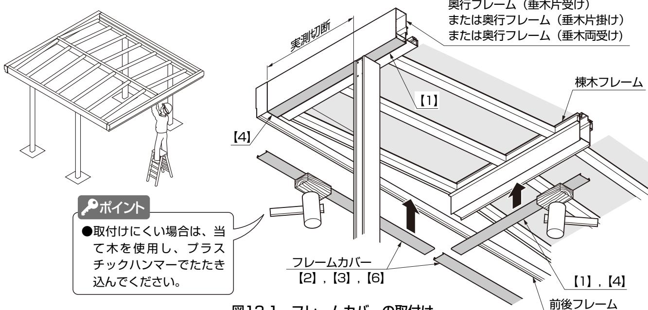
図12-1 フレームカバーの取付け
