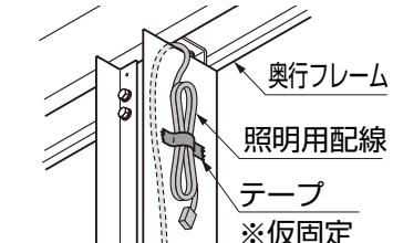
●LEDライトを取付ける場合、柱とフレームのすき間から配線を引出し、テープなどで仮止めしてください。
