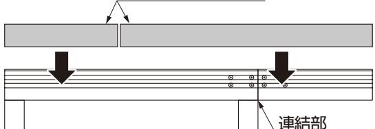
●持出し屋根の場合、連結部を隠すように前後フレームカバーを取付けてください。
