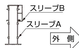
●フレームスリープは、取付ける場所により、スリープBの取付個数が異なります。
