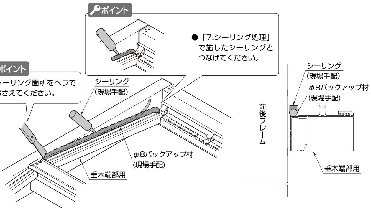
①垂木端部用と前後フレームのすき間にφ8バックアップ材を取付けてください。
