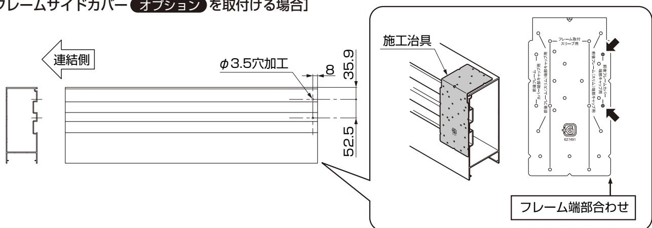
(2) 部品取付け ※図は前側を示します。後側も同様に作業してください。
