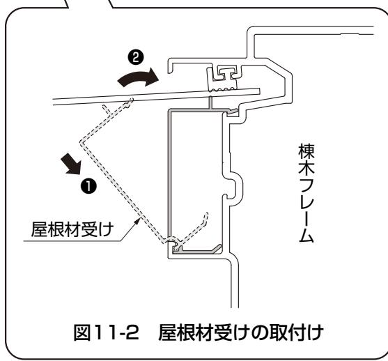
図11-2 屋根材受けの取付け
