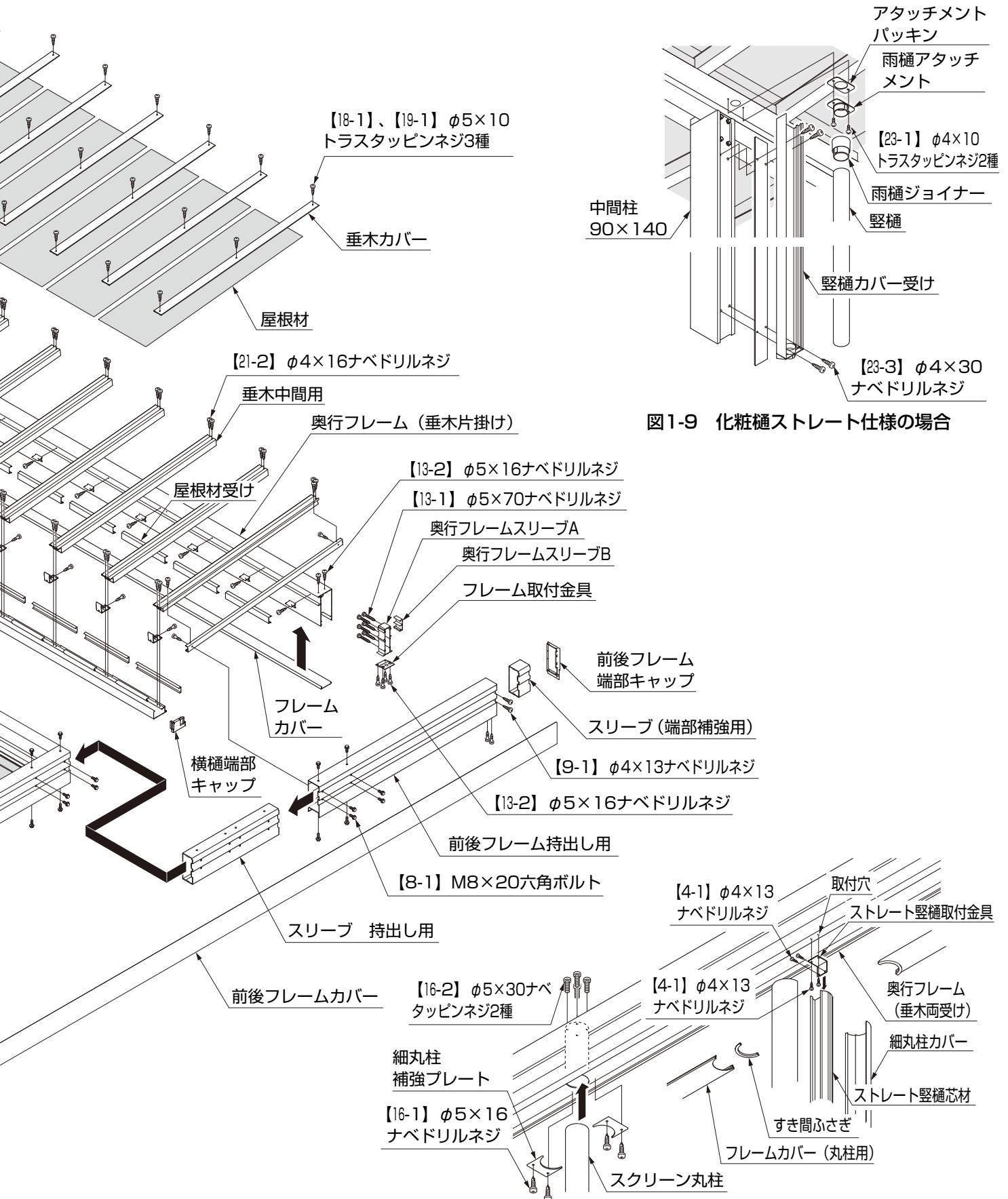
図1-10 スクリーン丸柱を使用する場合
