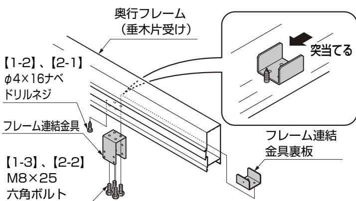
① 【1-2】、【2-1】を奥行フレーム（垂木片受け）に取付け、フレーム連結金具裏板を挿入してください。
