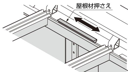
①屋根材押さえを屋根材中央に配置してください。
