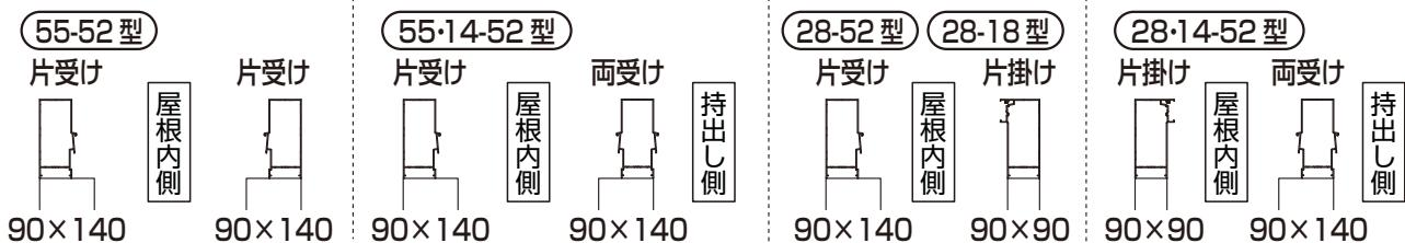
●施工タイプにより、柱と奥行フレームの組み合わせが異なりますので、上図で確認してください。
