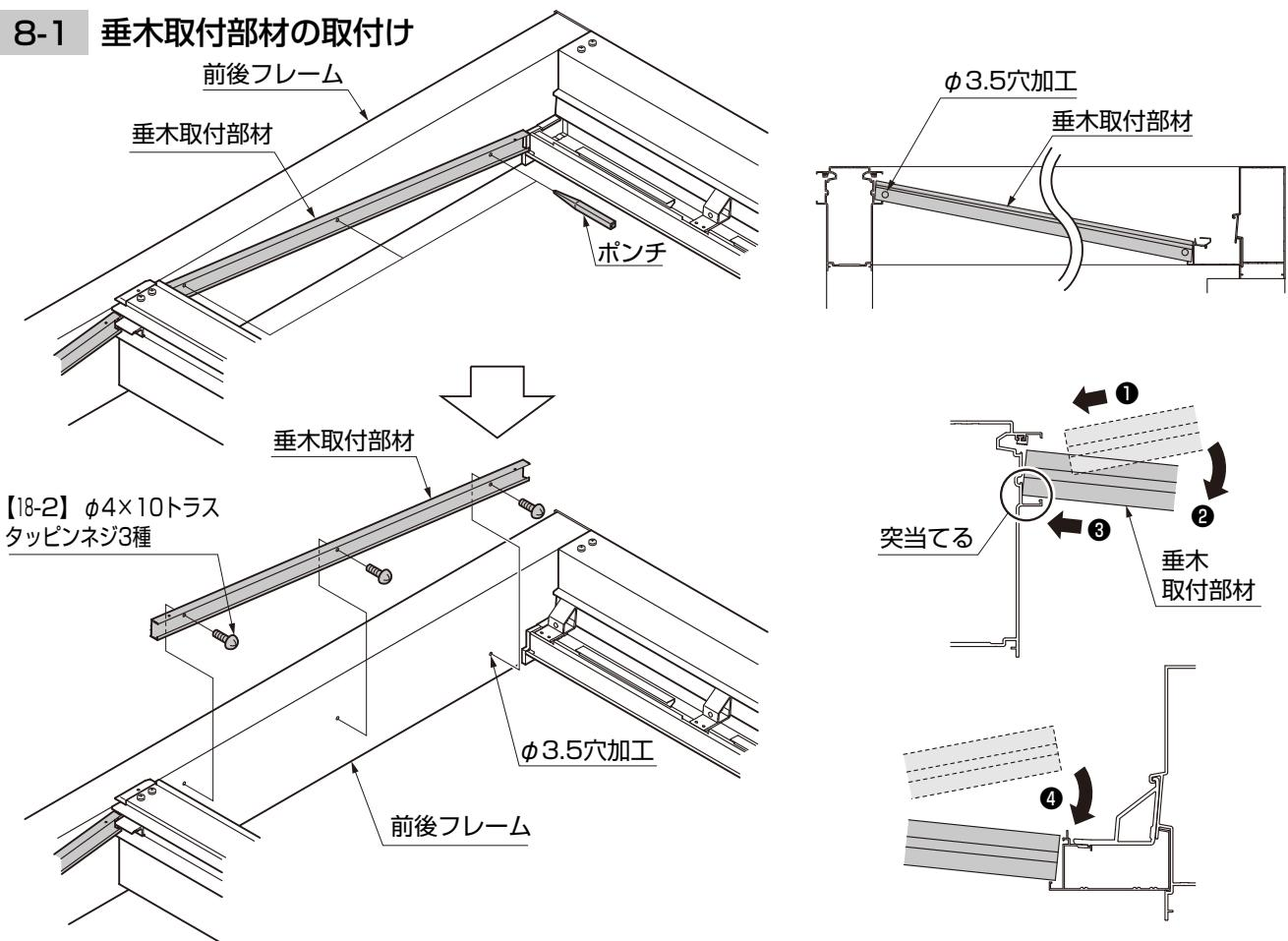
①垂木取付部材を仮置きしてポンチでけがき、前後フレームにφ3.5の穴加工をしてください。
