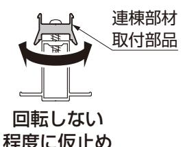
①連棟部材取付部品を連棟部材に【15-2】で仮止めしてください。
