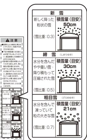
①P.7を確認し、現場の納まりに該当する積雪強度の雪下ろしシールを柱の見やすい位置に貼付けてください。
