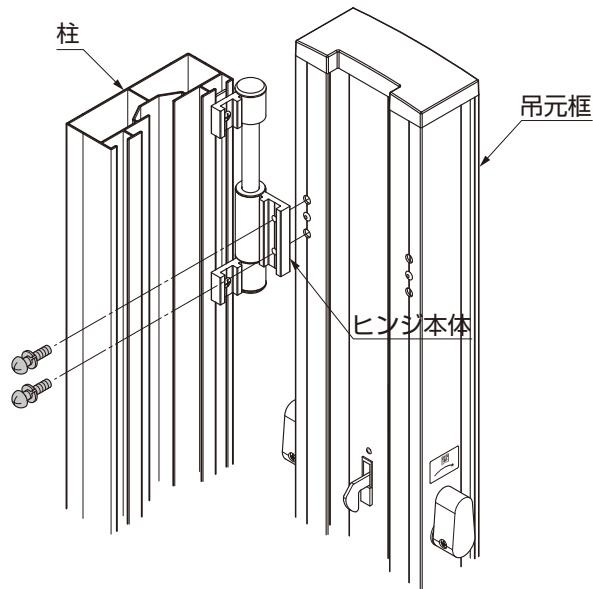
④取付けネジを締め付ける
