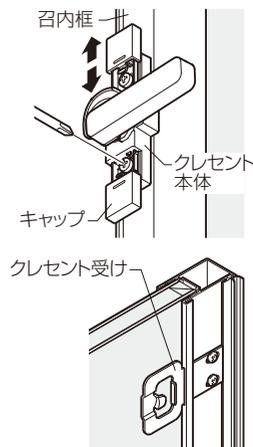
**お願い**…クレセントがかりにくくないか確認してください。かかりにくい場合は、クレセント受けを上図のように出る方向に調整するか、クレセントとクレセント受けの高さを戸車調整またはクレセント調整で合わせてください。かかりにくいまま使用すると、クレセントが動かなくなったり、破損したりするおそれがあります。
