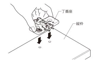
丁番座を縦枠にねじ( $\square$ タッピンねじ $\phi$ 4×16) で固定します。
