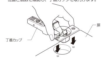
③丁番カップをねじ(皿タッピンねじ  $\phi 4 \times 16$ )で固定します。
