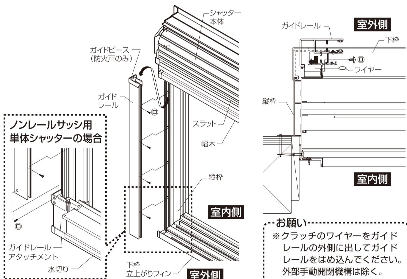
※リフォームシャッター三方枠納まりの場合、ガイドレールはデッキ面(地面)に合わせて取付けてください。
