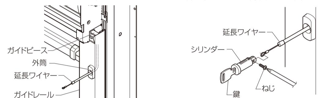
●シリンダーを外筒に挿入し、鍵を回してシリンダーを固定させます。
