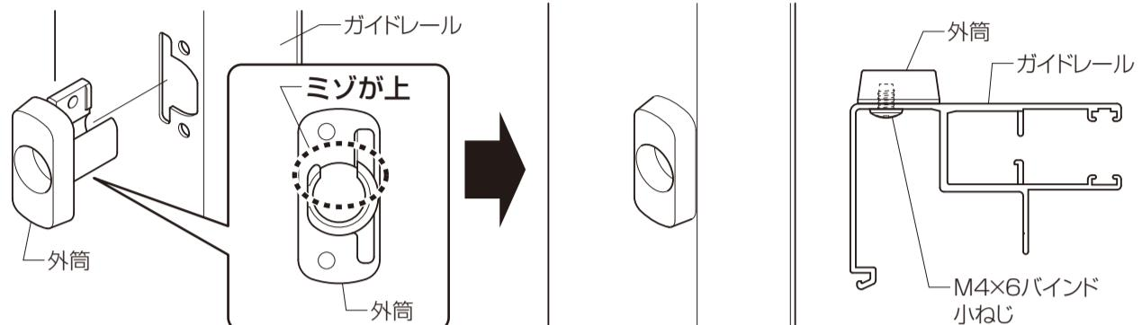
●ガイドレールの内側に延長ワイヤーを這わせ、外筒の穴から外側に露出させます。
