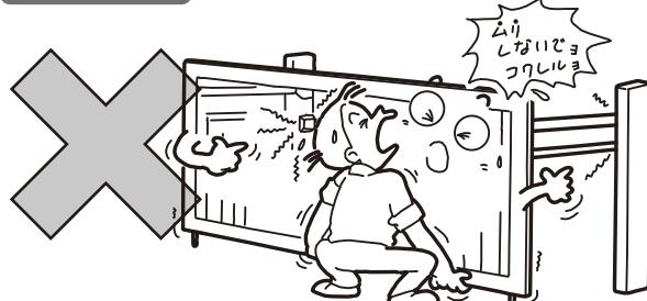
●電動状態(通電状態)のまま、無理に扉を開けないでください。駆動部などを破損する原因になります。
