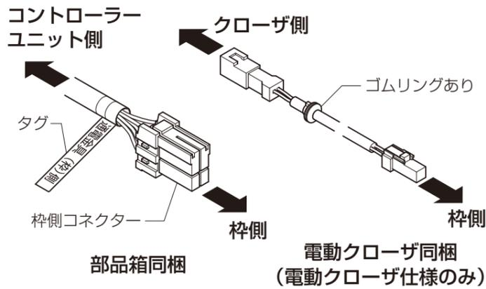
②躯体内配線コードの枠側コネクタは切欠き穴から確実に引き出してください。
