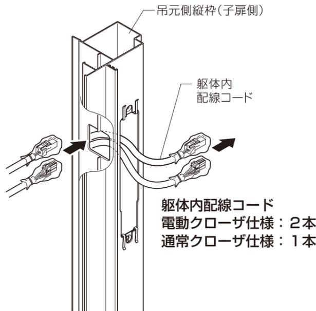
②コネクタを通電金具（枠側）に接続します。
