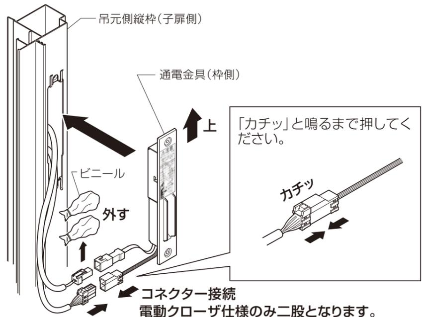
③通電金具（枠側）を枠に取付けてください。
